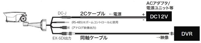
●専用ドライブユニット使用時(SLS-TA0251PVのみ)
