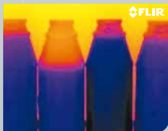
赤外線カメラでボトルの 容量不足／過多を検査
