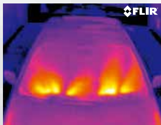
車のフロントガラスの 除霜装置の検査
